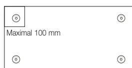
4 Stück pro Platte (1,2 x 0,6 m Platte – 5,55 / m 2 )
